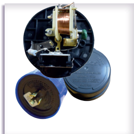
Foto celda electromecánica (Argos) -No rcomendada para LEDS -Protección MOV -100J
