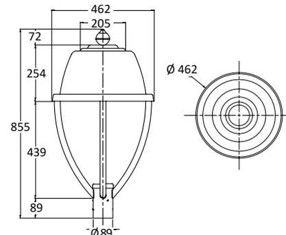
Con cúpula preparada para Telecontrol, Fotocelda y dispositivos de control especializado; incluye chimenea la cual debido a su extraordinario diseño permite una ventilación cruzada que garantiza la mayor durabilidad del driver y LED
