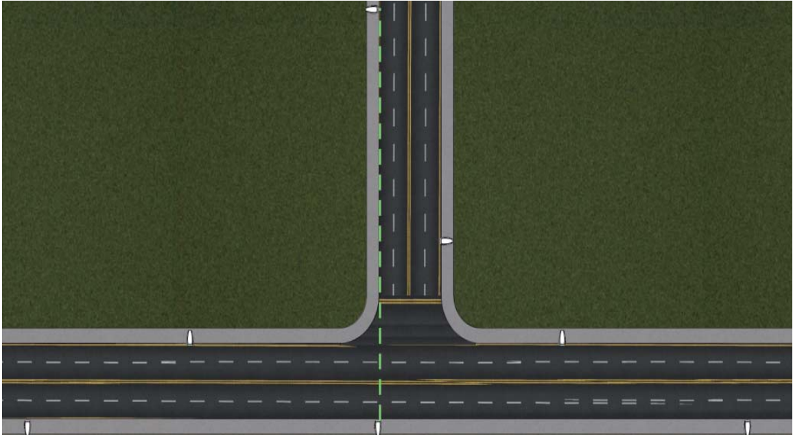
Figura 6.40 Ubicación de postes de alumbrado en una vialidad tipo "T" (Fuente: Recomendaciones para la iluminación de carreteras y túneles. Gobierno de España)
