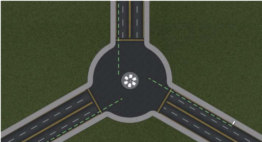
Figura 6.42 Ubicación de postes de alumbrado en glorieta (Fuente: Recomendaciones para la iluminación de carreteras y túneles. Gobierno de España)
