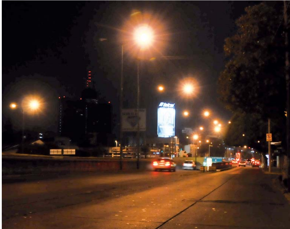
Figura 5.11 Ejemplo de avenida iluminada por luminarias equipadas con refractor
