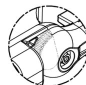
Utilizamos una abrazadera tipo U, que soporta hasta 150 kg (No utiliza prisinera)
