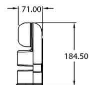
Permite colocar cualquier luminaire a un poste, aumentando los ángulos de movimiento de 0° a 180°.
