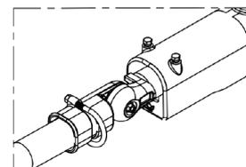
Sistema de engranes dentados que impide el movimiento una vez fijado el ángulo.
