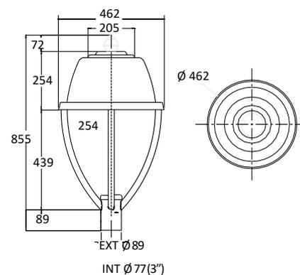
Con cúpula preparada para Telecontrol, Fotocelda y dispositivos de control especializado
